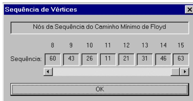
**Figura 20: Seqüência de 15 nós do percurso do caminho mínimo obtido da execução do algoritmo de Floyd para os nós 7, 56, 60, 21 e 63, ilustrado na figura 18.**
